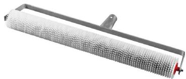
Игольчатый (ротационный, аэрационный) валик используется для удаления вовлеченного воздуха из лицевого слоя покрытия, а также, для перераспределения материала на поверхности. Валик должен быть чистым без следов композиции, влаги, растворителей, моющих средств, смазок и пр. Все сегменты должны быть легко подвижны. При движении валика по основанию – все сегменты должны касаться поверхности. В противном случае необходимо использовать игольчатый валик меньшей ширины.
